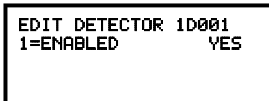
Pantalla Selección Activación/Desactivación
